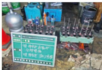
吸・排気弁 起動弁分解整備
